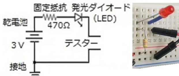
図1. 第一回で制作する回路図とその実体
